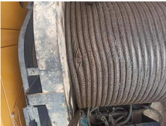
图 8 罗田水库-铁岗水库输水隧洞工程 SCC 型 150t 履带式起重机副起升钢丝绳局部变形。
