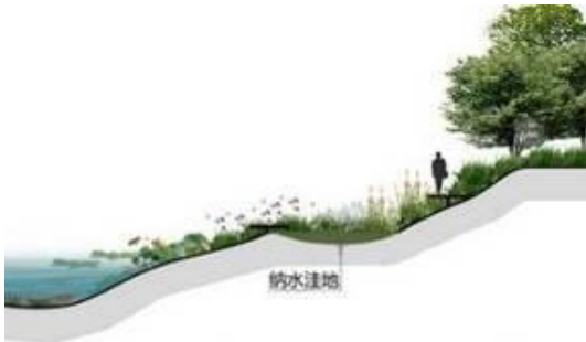
图 6-6 生态缓冲带断面示意图
