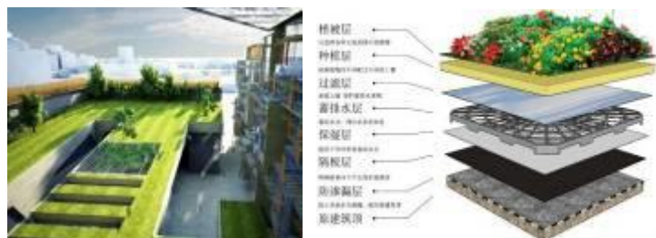
图 6-2 屋顶绿化层结构
