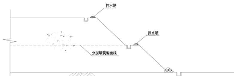
图3 填方边坡水土保持示意图
