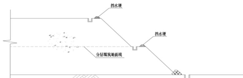
图3 填方边坡水土保持示意图
